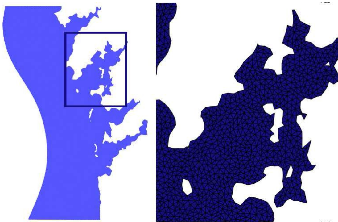
Fig. 4.1: Malla de cálculo con división en polígonos menores por medio de un algoritmo de triangulación condicionada.
