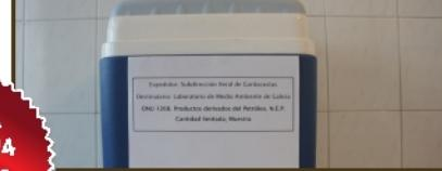
Guardar el frasco en el envase térmico e introducirlo en la bolsa de toma de muestras con su precinto correspondiente.
