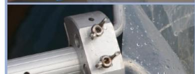
Unir aro y mango mediante el adaptador
