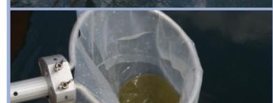
Dejar la muestra dentro del cono el tiempo suficiente para que decante el agua
