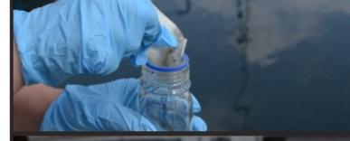
Guardar el frasco en el envase térmico e introducirlo en la bolsa de toma de muestras con su precinto correspondiente
