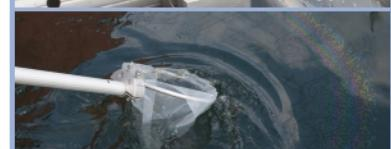
Recoger la muestra con el dispositivo aro-mango-cono
