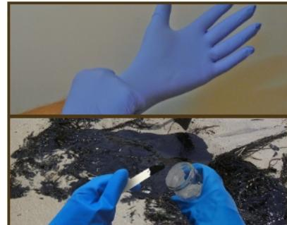
Coger el frasco de muestra con una mano y la tapa con la otra.
