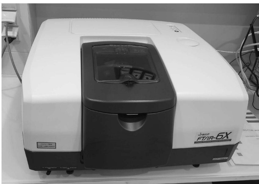
Figura 2. Fotografía del equipo Jasco FTIR-6X con ATR PRO ONE
